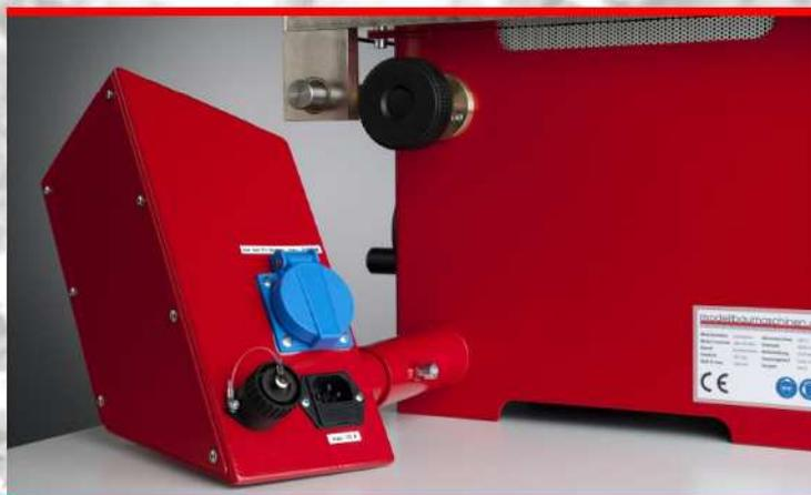
Connections possibles: interrupteur à pied et aspiration.
