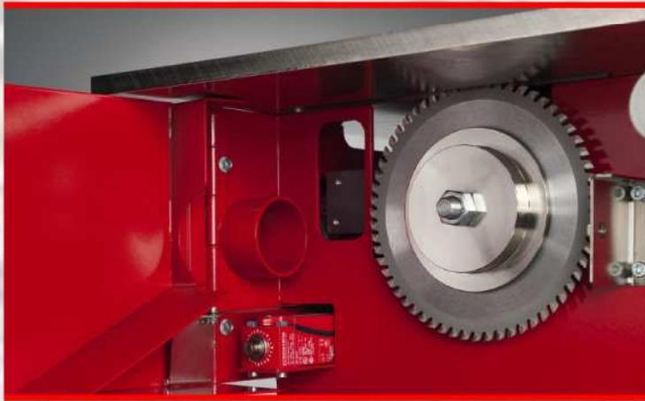
Das Sägeblatt ist mit wenigen Handgriffen mühelos ausgetauscht.
