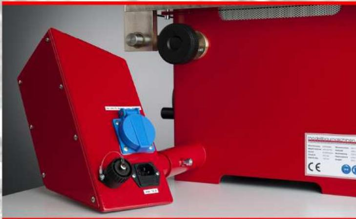
Anschluss für Fußschalter und Absaugung.
