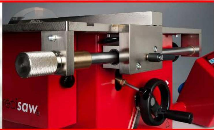
Die "precisaw®" ist mit zwei unabhängigen Messcomputern ausgestattet. Dank der genauesten Distanzmessung der X- und Z-Achse, kann auf das Messen und Anzeichnen am Werkstück grösstenteils verzichtet werden:
